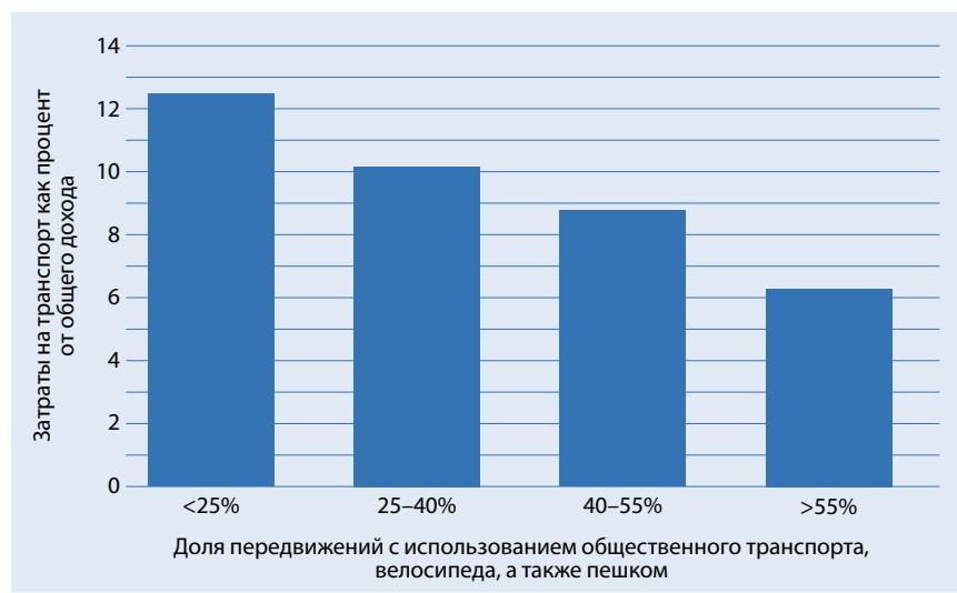
Рис. 2. Коммунальные затраты на транспорт как процент от общего дохода местного сообщества, в зависимости от вида транспорта
